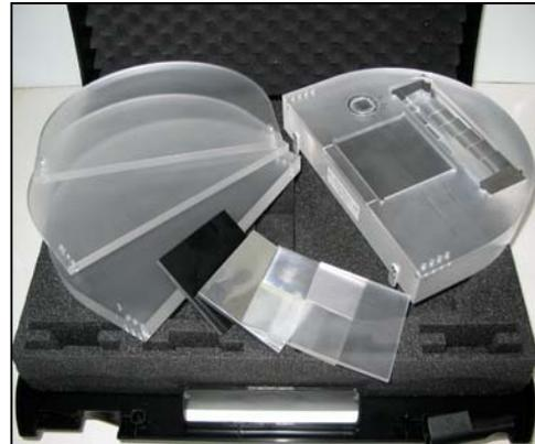
Bild 1: Prüfkörper NORMI PAS Set
