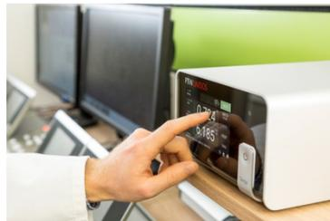
**Bild 4:** UNIDOS Tango und Romeo sind die ersten Elektrometer mit einem kapazitiven Touchscreen. Eine intuitive, mehrsprachige Benutzeroberfläche ermöglicht einen schnellen Zugriff auf alle Einstellungen.
